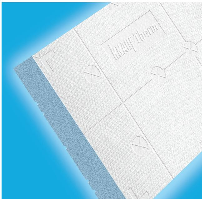
**KNAUF Therm® Теплая стена** – формованная плита ETICS для наружного утепления зданий. Данный продукт применяется в системах «мокрых» фасадов с тонким штукатурным слоем. Благодаря технологии термоформования в процессе производства отсутствует этап резки, и гранулы пенополистирола остаются цельными, что позволяет добиться улучшенной геометрии и технических характеристик.
